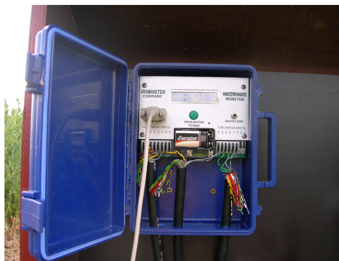
Abb. 5: Watermark-Monitoring - die erfassten Daten können über Notebook heruntergeladen werden
