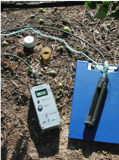
Abb.2: TDR-Messgerät zur Messung des Bodenwassergehaltes (volumetrische Messung)
