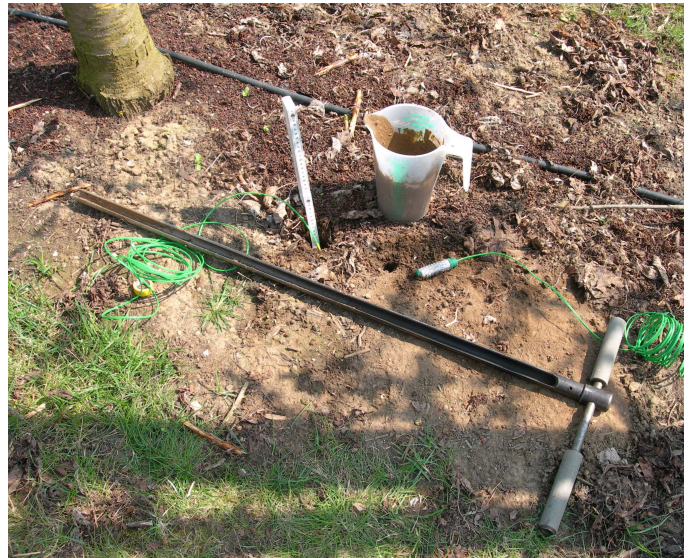
Abb. 7.: Mit einem Pürckhauer Bohrstock wird ein Loch vorgebohrt, anschließend wird der feuchte Watermark-Sensor in der gewünschten Bodentiefe eingeschlämmt.
