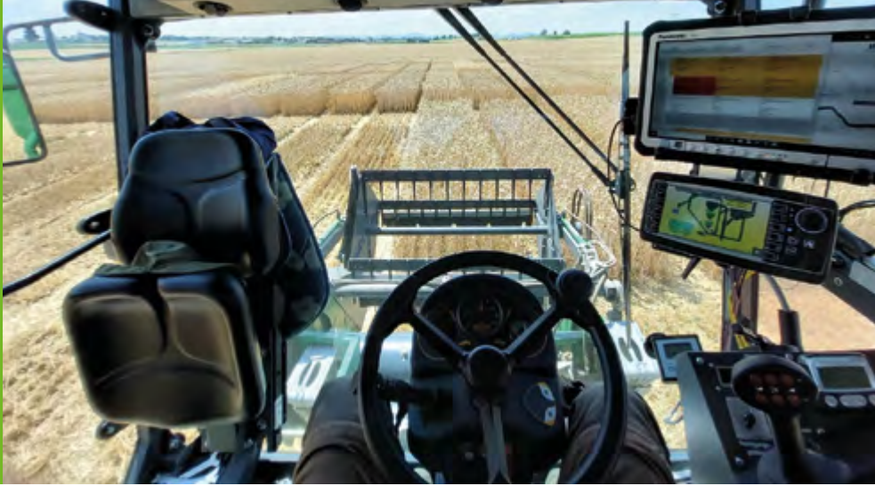
Abb. 2: Ernte des Versuches S151 – Landessortenversuch Winterweizen in Herxheim. Kleiner Computerbildschirm: Schiebersteuerung inklusive Wiegesystem. Großer Computerbildschirm: Lageplan mit Ernteparzellen und ange-schlossenem NIR-System.
