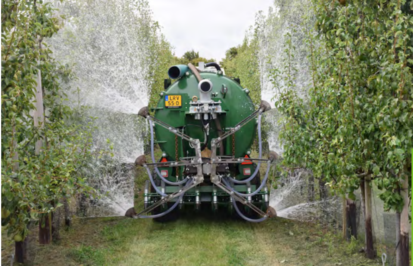
Abb. 2: Güllefass mit Sprühkopf zur Bekämpfung des Birnenblattsaugers mithilfe von Wasser
